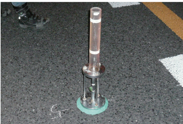
写真 6-3-5 現場透水試験
