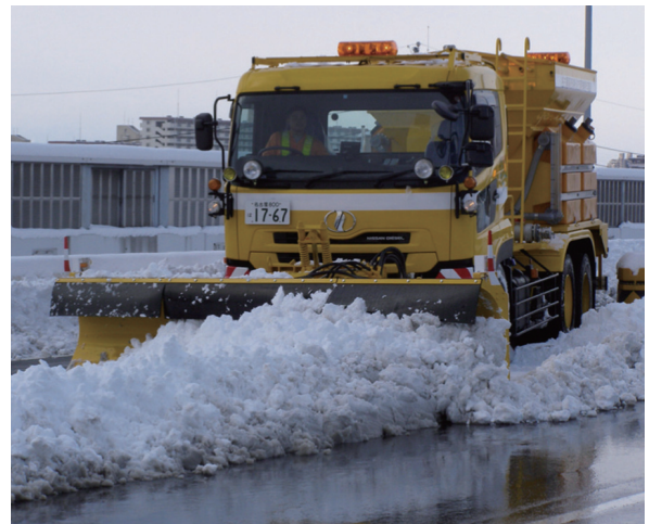
写真 6-1-1 除雪兼用車による雪氷作業
