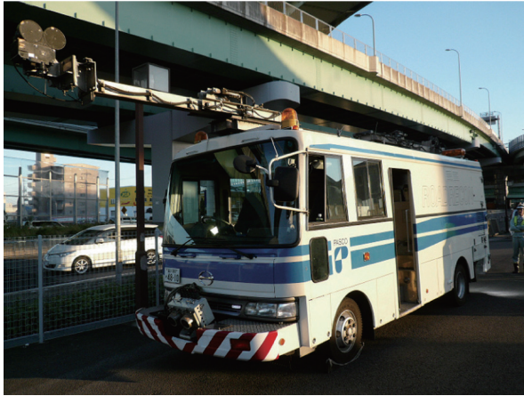
写真 6-3-4 路面性状測定車
