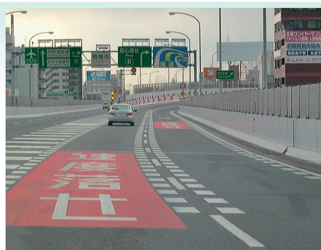
JCT 分岐点手前のカラー塗装による速度抑制（鶴舞南 JCT）
