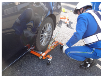
《ジャッキ設置》
