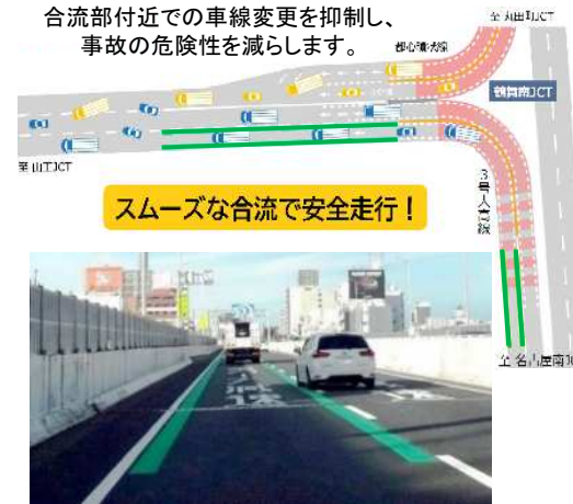
車線キープグリーンライン対策(鶴舞南JCT合流部)
