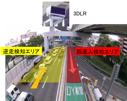
三次元レーザーレーダの試験状況 (高針出入口)
