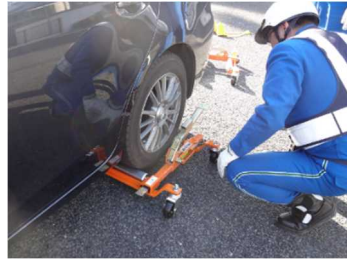
《ジャッキ設置》
