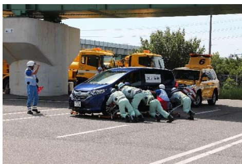
《ジャッキによる放置車両移動》
