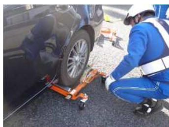
《ジャッキ設置》
