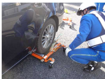
《ジャッキ設置》
