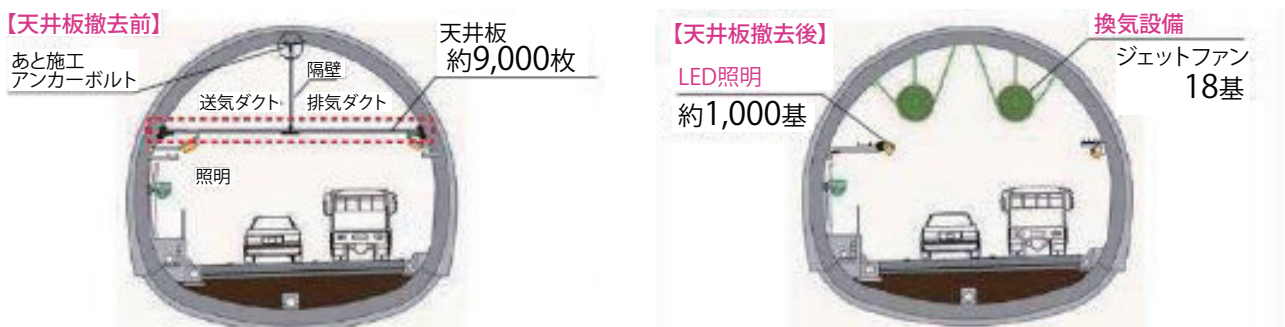
図3-2-6 東山トンネルの天井板撤去前後の構造の比較
