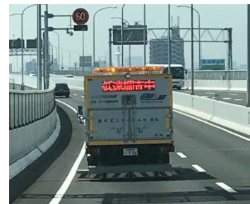
非破壊検査技術 (床版内部診断技術)
