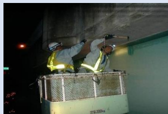
高所作業車での打音検査
